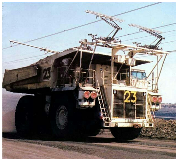
Рис. 2. Карьерный самосвал Siemens – троллейвоз
